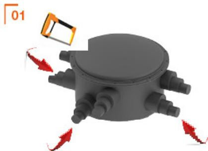
Обрежьте патрубок подземного смотрового колодца в соответствии с необходимым диаметром кожуха трубопровода. Патрубок Ø 120 для кожуха 110 мм, Ø 170 для кожуха 140/160 мм и Ø 235 для кожуха 75/90/200/225 мм. Для кожуха диаметром 75 и 90 мм используйте RAS200/75 и RAS200/90.
