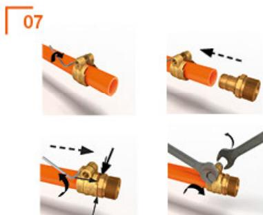
Установите все необходимые соединения напорных труб внутри колодца в соответствии с инструкциями по монтажу соединений для труб PE-X.
