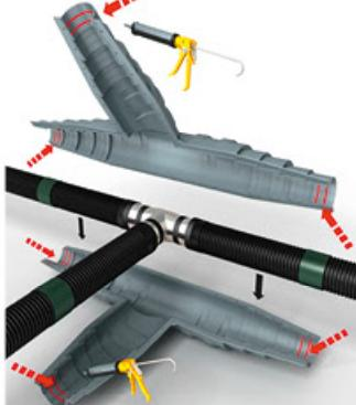
Нанесите две линии герметика с минимальной толщиной 5 мм и шириной не менее 4 мм на все концы обеих оболочек.
