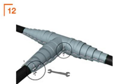
Соедините обе половины оболочки с помощью прилагаемых болтов из нержавеющей стали. Все болты должны быть затянуты до тех пор, пока герметик не будет выдавлен на концах корпуса.
