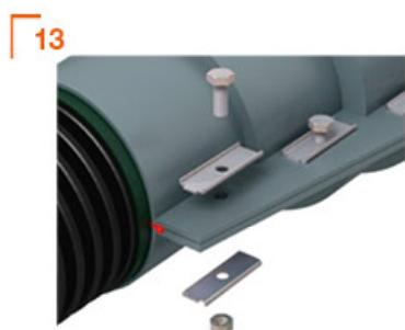
Используйте пластины и болты из нержавеющей стали для стягивания корпуса. Во внутреннем углу используйте шайбы вместо металлических пластин.
