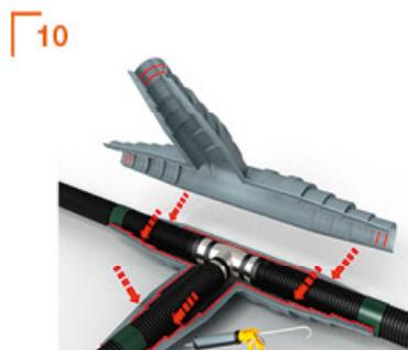
Применяйте герметик в области канавок, пока ширина канавки не будет полностью заполнена.
