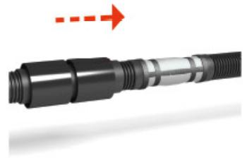
Надвиньте прямую гильзу, пока оба конца предварительно изолированного трубопровода не будут покрыты. Затем надвиньте оба термоусадочных рукава так, чтобы каждый из них наполовину покрывал прямую гильзу и кожух трубопровода.
