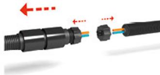
Наденьте прямую гильзу с двумя термоусадочными рукавами из комплекта на одну часть трубопровода и установите термоусадочные колпачки на оба торца трубопровода (не входят в комплект, заказываются отдельно).
