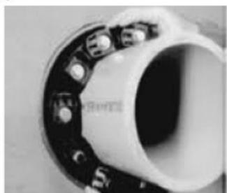
Сдвиньте уплотнитель в сборе в кольцевое пространство. Для уплотнителей большого размера начните вставлять цепь в сборе в положение «6 часов» и продвигайте обе стороны вверх в направлении положения «12 часов» в кольцевом пространстве.
