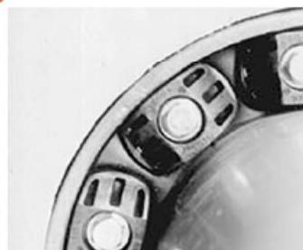
Не затягивайте болты более, чем на 4 оборота за раз. Сделайте еще 2 или 3 прохода при 3 оборотах на болт, до тех пор, пока звенья не будут равномерно сжаты и макс. крутящий момент (см. таблицу) достигнут.
