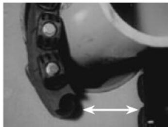
Ослабьте заднюю прижимную пластину с помощью гайки настолько, чтобы звенья свободно перемещались относительно друг друга. Соедините оба конца цепного уплотнения.
